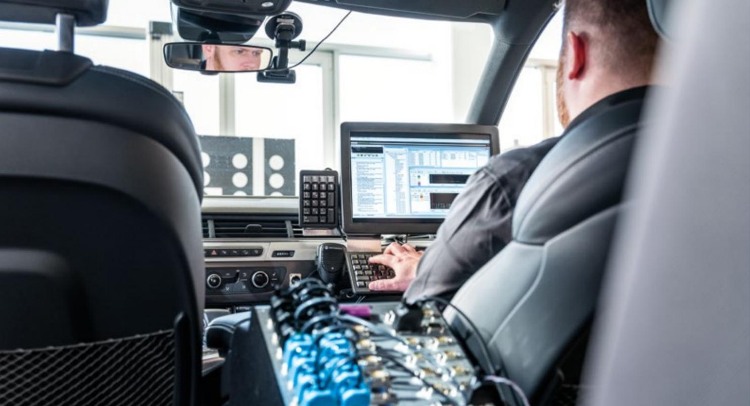
Ausstattung eines Fahrzeugs mit Messtechnik für den Fahrversuch
