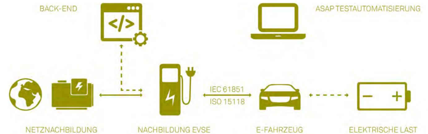
Grafische Darstellung eines Labor-Prüfplatzes zur Ladeabsicherung von E-Fahrzeugen
